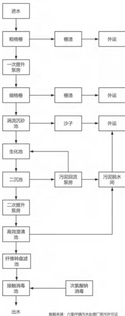
图5.2-2 六里坪镇污水处理厂工艺流程
